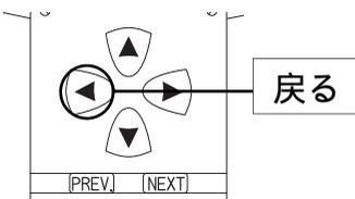
、設定する項目を選択時左図の操作を行い、設定する番号の選択に戻ります。同様の手順で設定する項目の選択過給圧、ベースデューティの設定を行ってください。
