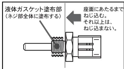
△注意 吸気温センサは、マツダ(株)純正部品 N3A118 845を使用してください。液体ガスケットが完全に乾くまで(塗布後、半日程度)は、エンジンを始動しないでください。
