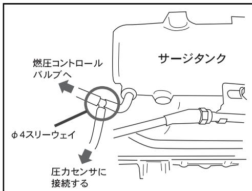
1. 燃圧コントロールバルブに向かう配管にφ4スリーウェイを取付ける。
